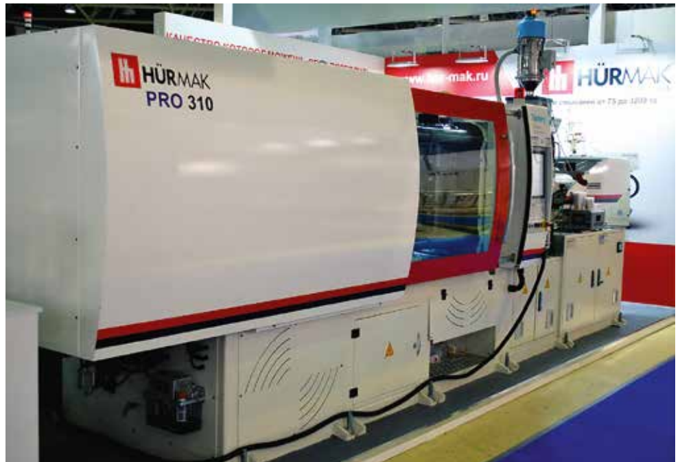
Компания Hürmak, крупнейший турецкий производитель ТПА, представила высокоскоростную литьевую машину PRO 310 с боковым роботом. Автоматизированный комплекс по производству пищевого стаканчика для йогурта по так называемой технологии «вклеенной этикетки» оборудован шестигнездной горячеканальной формой, боковым роботом и, собственно, гибридной скоростной инжекционно-литьевой машиной с усилием смыкания 300 т. Время цикла составляет менее 5 секунд
