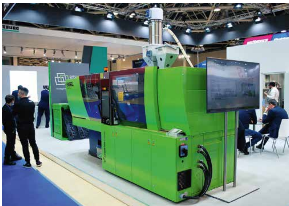
ENGEL, машиностроительное предприятие из Австрии, представило в работе бесколонный термопластавтомат ENGEL victory с усилием смыкания 80 т. ТПА разрабатываются в компании ENGEL уже более 30 лет, и сегодня тысячи заказчиков во всему миру пользуются преимуществами бесколонных машин. В Россию и Беларусь уже поставлены более 1050 бесколонных термопластавтоматов серии victory
